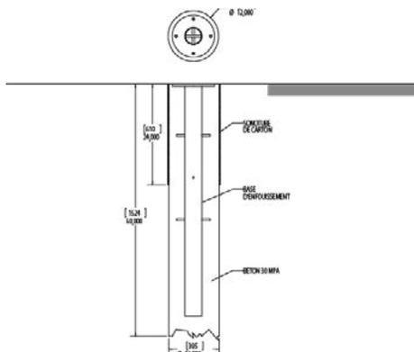
Pour les installations sur asphalté ou sur gazon, un cylindre de béton (type sonotube) renforcé avec d'une base d'enfouissement sera nécessaire pour un maximum de solidité. Il suffit de creuser un cylindre d'un diamètre de 305 mm (12") et d'une profondeur de 1524 mm (60"), d'y coulé du béton 30 Mpa et d'y insérer la base d'enfouissement en respectant l'orientation.
