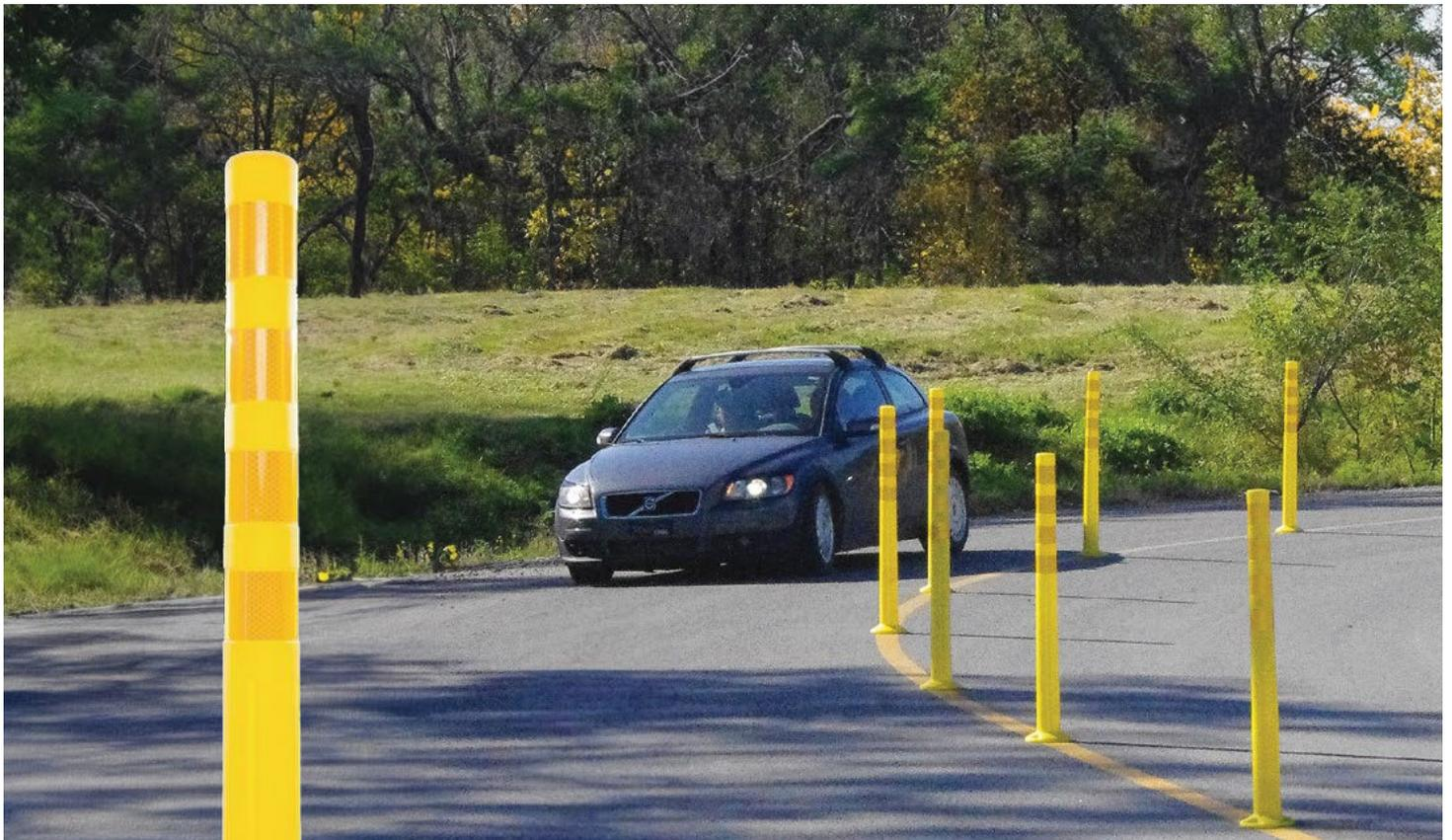
Le poteau délimiteur Deflex est fabriqué en polymère flexible et reprend sa forme initiale même après plus de 200 impacts, à 55 mph (88 km/h) avec une installation sur bouclier d'asphalte. Selon les résultats des tests NTPEP, vous pouvez atteindre ou dépasser 200 impacts si l'installation suit ce modèle.
