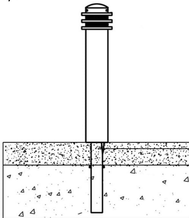
Système d'ancrage durable et simplifié pour maintenance rapide en cas d'impact et à faible coût.
